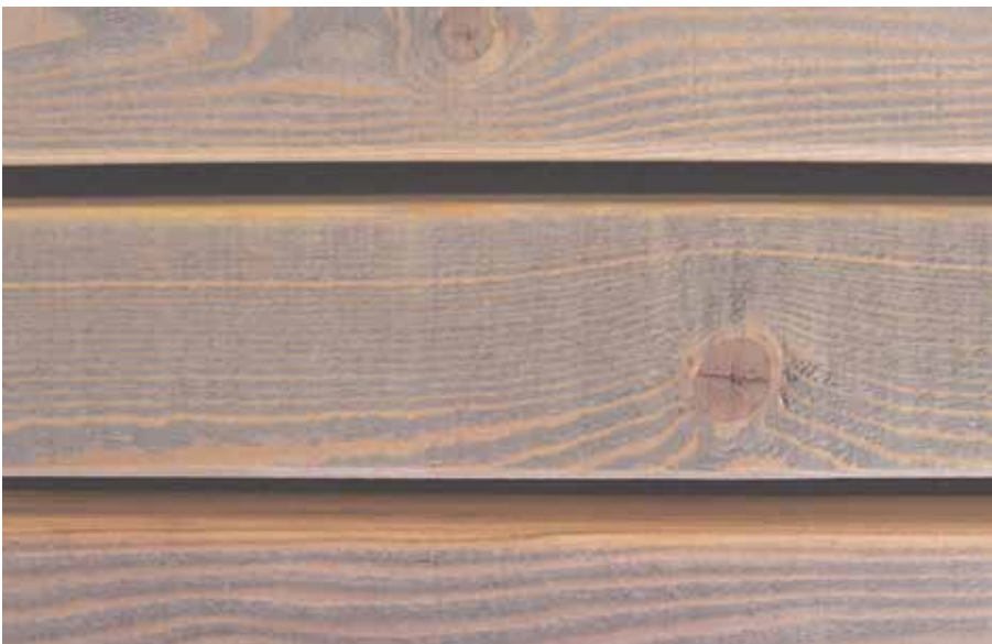
Rhomboid-Profil sibirische Lärche Sichtseite feingesägt 4 Längskanten gerundet, Radius 4 mm 1x grundiert (als Vergrauungslasur) mit OSMO Holzschutz Öl-Lasur 905 Patina mit Filmschutz gegen Algen- und Pilzbefall, enthält biozide Wirkstoffe, Verwendung nur für außen
